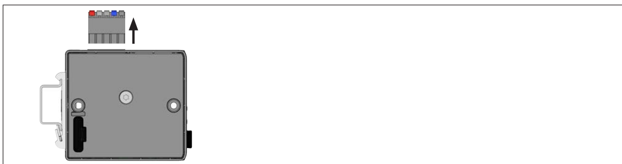
Bild 25: 5-polige Federzugklemme entfernen
