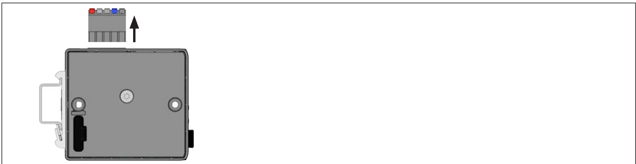
Bild 29: 5-polige Federzugklemme entfernen
