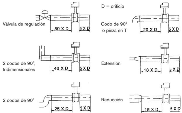
El sensor del caudal puede instalarse en tuberías horizontales o verticales
