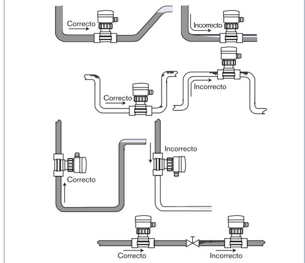
El tamaño de tubería adecuado debe seleccionarse utilizando el diagrama de Caudal/Velocidad/DN. Deben respetarse las presiones y temperaturas nominales del material con que está fabricado el fitting seleccionado.
