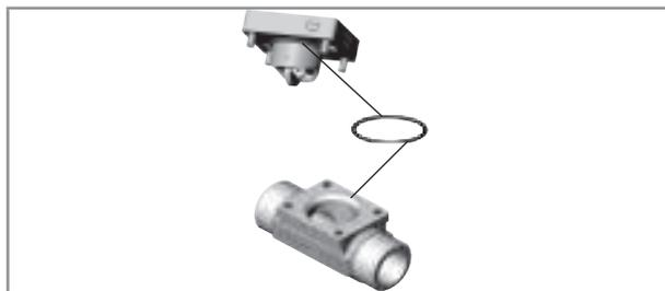
Bild 5: Dichtungsposition bei einem Fitting S030 HT
