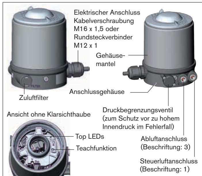
Bild 2: Aufbau für Prozessventile der Reihe 21xx
