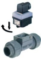
Le débitmètre 8030 s'installe aisément sur les conduites à l'aide des systèmes de raccordement INLINE Bürkert (Type S030) par quart de tour. Des distances minimales en amont et en aval du capteur doivent être respectées. Selon le profil de la canalisation, les distances nécessaires peuvent être plus importantes ou nécessiter un redresseur d'écoulement pour obtenir une plus grande précision. Pour plus d'informations se référer à la norme EN ISO 5167-1.
